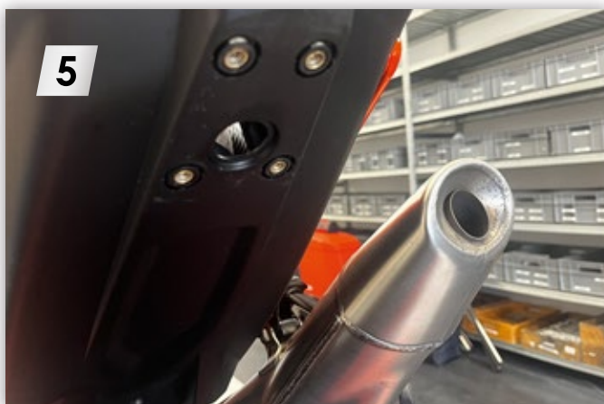
MIZU FLY-Design Kennzeichenträger mit originalen Schrauben montieren Mount license plate holder with original screws
